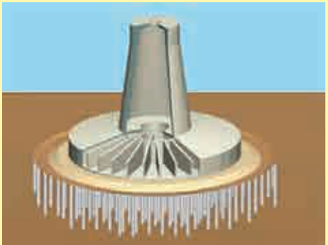
3. Ένας από τους 4 πυλώνες από την κορυφή του οποίου κρέμεται με συρματόσκοινο η γέφυρα
