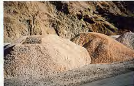
Αυτό είναι το υλικό του 3Α Λατομείου που απαιτείται και χρησιμοποιείται για τα τεχνικά έργα του δρόμου ΡΟΔΑΥΓΗΣ-ΠΛΑΚΑΣ. Το αρμοχάλικο από το ποτάμι (ακατέργαστο) είναι επικίνδυνο...
