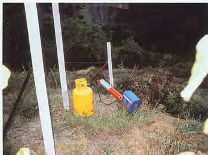
ΤΟ ΕΙΚΟΝΙΚΟ ΚΑΝΟΝΙ ΤΟΥ ΒΑΣΙΛΗ ΛΑΜΠΡΟΥ ΚΑΠΡΟΥΤΣΟΥ. Το σύστημα εκπέμπει ασφαίρες βολές κάθε 10-15 λεπτά για τον εκφοβισμό των πουλιών και των άγριων ζώων για να μην καταστρέφουν τη σοδειά (Σταφύλια κ.λπ.). Το είχε τοποθετήσει ο αείμνηστος Λάμπρος Καπρούτσος.
