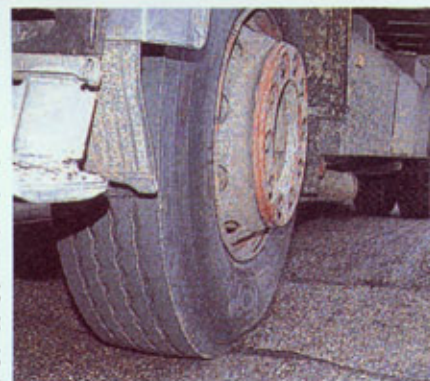
Βαρέα οχήματα. Σύμφωνα με μελέτη του Πανεπιστημίου του Κέμπριτζ ένα φορτηγό μεικτού βάρους 40 τόνων ταλαιπωρεί τόσο την ασφάλτο όσο 160.000 Ι.Χ. βάρους ενός τόνου το καθένα.
